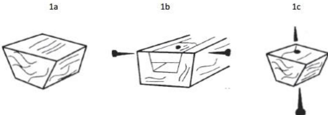
V prípade, že je potrebné jednotlivé kusy PS trámov spájať, je to možné aj pomocou tzv. imitácie kovania, ktorú pripojíte v mieste spoja PS trámov a prichytíte priloženými ozdobnými klinčekmi.
